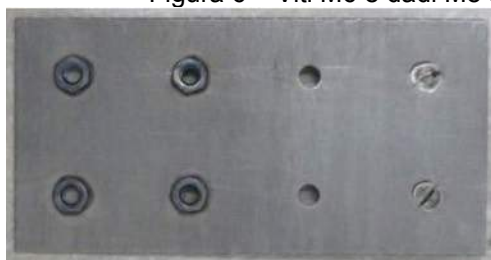
Figura 6 – Viti M6 e dadi M8 saldati su lastra metallica
