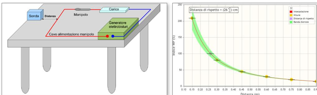
**Figura 1.** Set-up sperimentale (a sinistra) e grafico ottenuto dall'interpolazione di distanze ed indici per i lavoratori in WebNir (a destra). Il grafico è relativo ad un'impostazione della potenza pari a 100W, ed un carico di 400  $\Omega$ , in modalità fulgurate con i cavi di andata e ritorno mantenuti a 10 cm di distanza.
